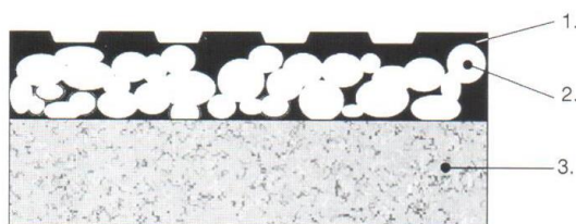
Bild 7: Aufbau der Buchse Typ BK-2
